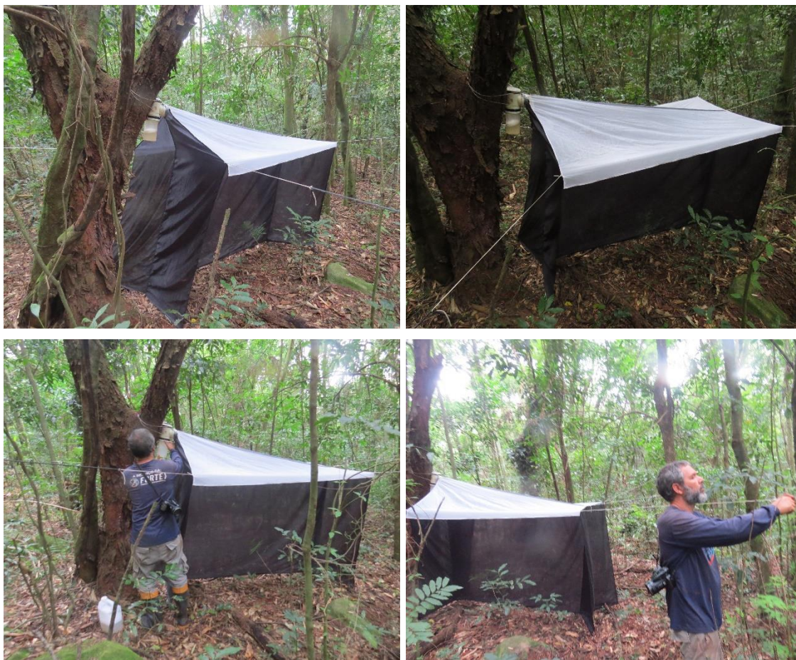
Figura 8 - Armadilhas tipo Malaise utilizadas para amostragem da entomofauna nas áreas de influência direta (AID) da CGH Teles de Proença.
