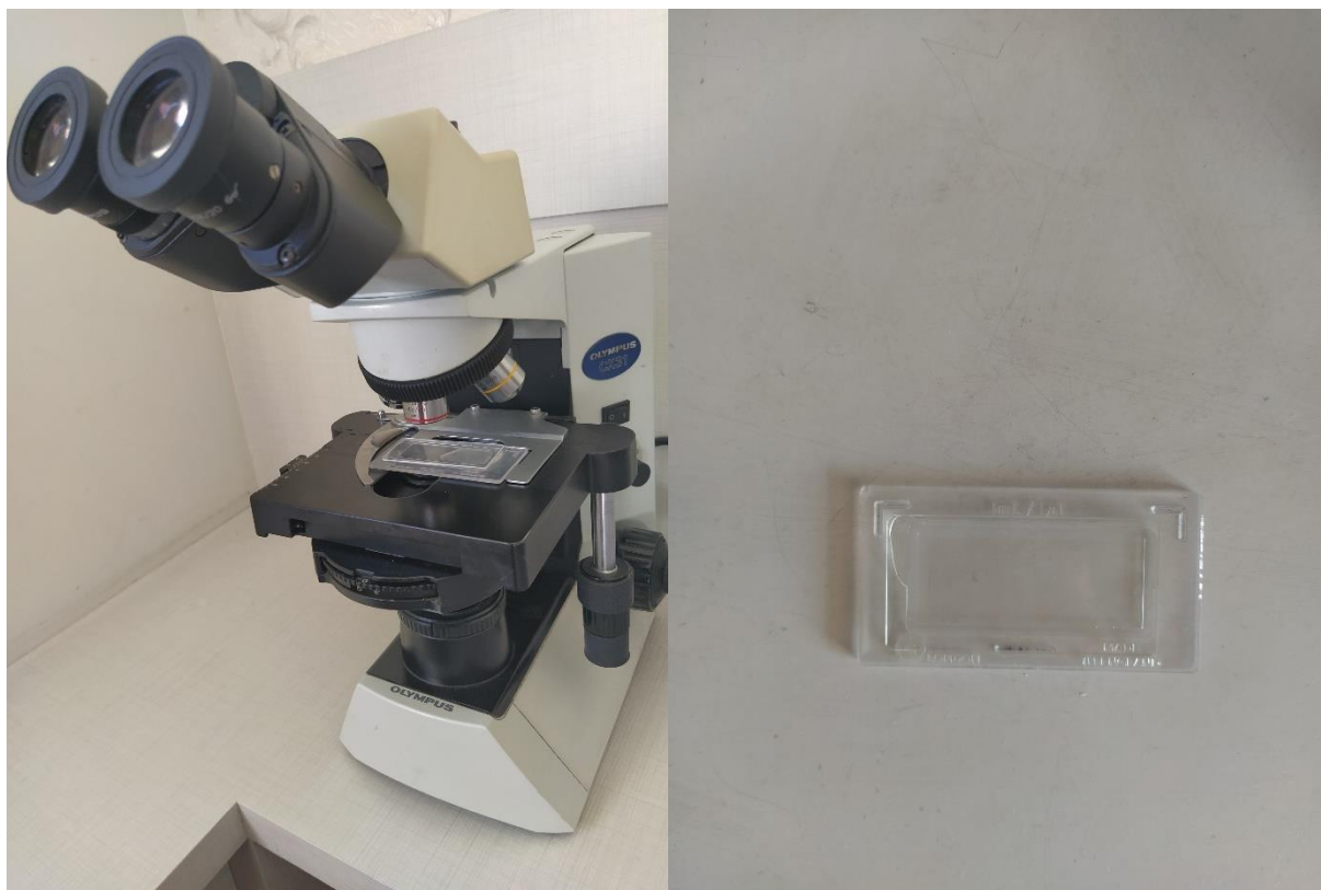
Figura 7 - Microscópio óptico e câmara de Sedgwick-Rafter utilizados para contagem e identificação do zooplâncton em laboratório.
