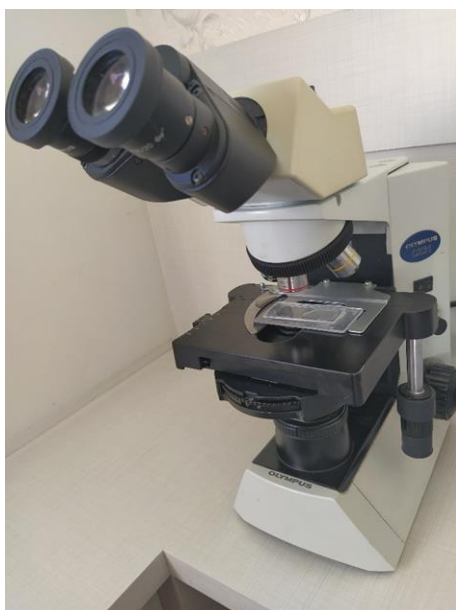
Figura 63 - Microscópio óptico e câmara de Sedgwick-Rafter utilizados para contagem e identificação do zooplâncton em laboratório.
